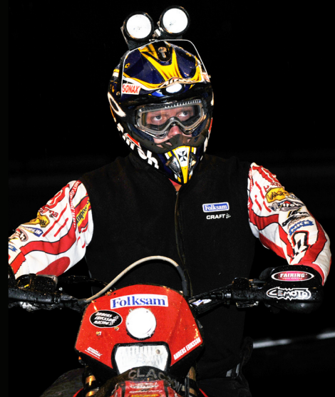
Anders Eriksson 3:a Kåsan 2007. Kokusankonverterad Husqvarna -08 med 3-fassystem > 200W. Dubbelmontage EMX hjälmlyjus. Hojljus, eget. Allt hojdrivet.
