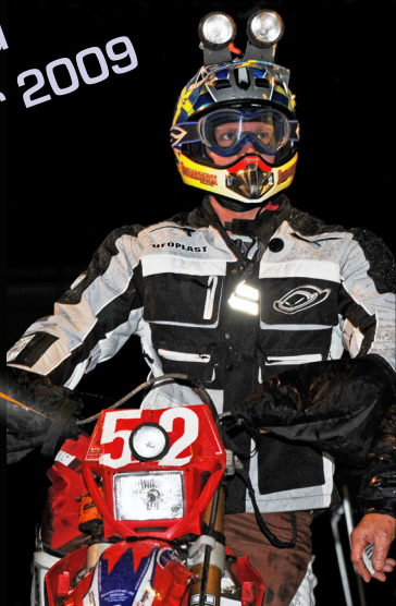
Daniel Johansson 9:a Kåsan 2007. GasGas 300EC. Elsystem: 3-fassystem > 200W. Dubbelmontage EMX hjälmlyjus. Hojljus infälld EMX hjämlampa. Allt hojdrivet.
