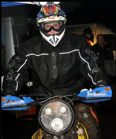
Jocke Ljunggren, 1:a Kåsan 2007. Husaberg. Elsystem: 3-fassystem > 200W Dubbelmontage EMX hjälmlyjus, hojljus Trail Light med tre gasurladdningslampor. Allt hojdrivet.
