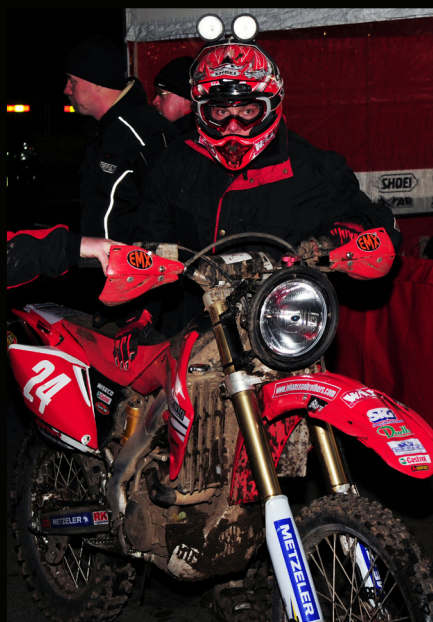
Calle Bjerkert, 1:a Kåsan 2008. Elsystem, ca 100W. Dubbelmontage EMX hjälmlyjus, hojljus EMX-HIDBL8. En hjämlampa batteridriven, resten hojdrivet.
