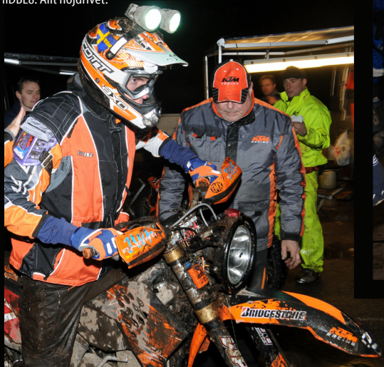
Fredrik Georgsson, bröt Kåsan 2007. KTM EXC-F -08 med Vortexbox. 3-fassystem > 200W Dubbelmontage EMX hjälmlyjus. Hojljus EMX-HIDBL8. Allt hojdrivet.
